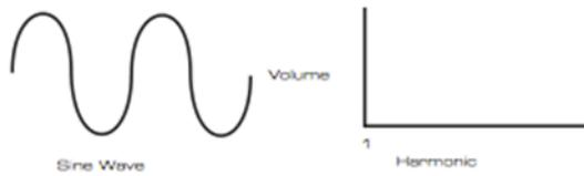
Queste onde possiedono solo un'armonica. Un'onda sinusoidale produce il suono "più puro" proprio perché ha questa singola intonazione (frequenza).
