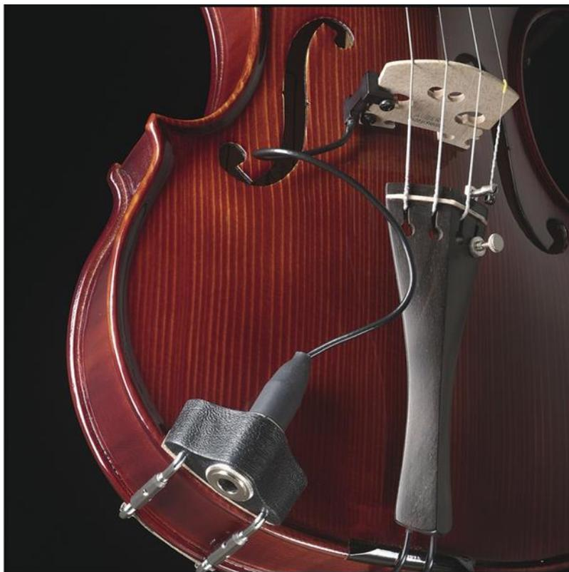
I pick-up piezoelettrici sono dispositivi in grado di rilevare le variazioni di pressione esercitate da una corda in vibrazione di uno strumento musicale generando un segnale elettrico che poi viene amplificato.
