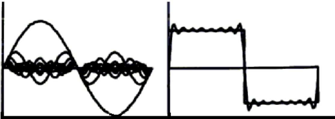
Ora che abbiamo messo a fuoco che un'onda quadra è il risultato della somma di più onde sinusoidali (armoniche dispari del suono fondamentale) possiamo finalmente spiegare il perché sia necessario conoscere queste nozioni per comprendere il funzionamento dei processori di dinamica atti a produrre distorsione.
